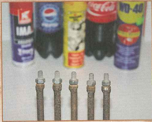
▲ De proef met handvast gedraaide moeren op licht gecorrodeerd schroefdraad gaf geen al te groot verschil te zien. Ook cola smeert.
