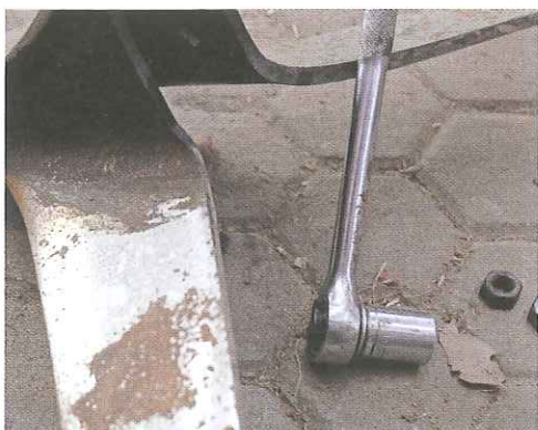
▲ Bij het losdraaien van moeren van cultivator-tanden maakte WD-40 de beste indruk.
