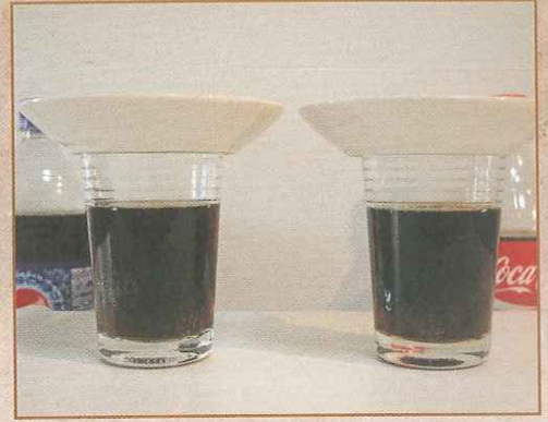
▲ Na een week in de cola bij 15 graden Celsius bleek de corrosie op de bouten enkel nat maar niet opgelost.
