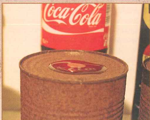
▲ De cola's blijven gewoon op hun plek liggen en vloeien niet uit. Ook vertonen ze geen tekenen van hechting aan het metaal.
