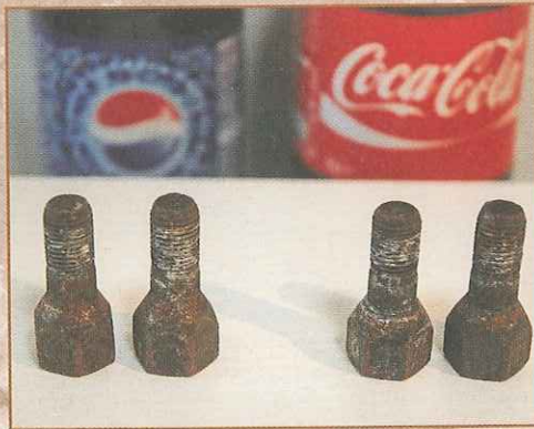
▲ Vier aangetaste wielbouten gingen twee aan twee in een glas met Pepsi-Cola en een glas met Coca-Cola.
